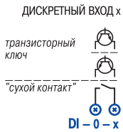
Схема подключения дискретных входов ПЛК100
