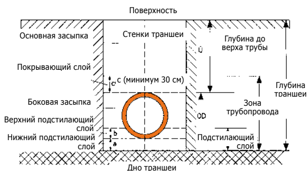
Рис. 3 Устройство траншеи
