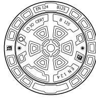
Телескопическая труба с чугунным люком TL-400
