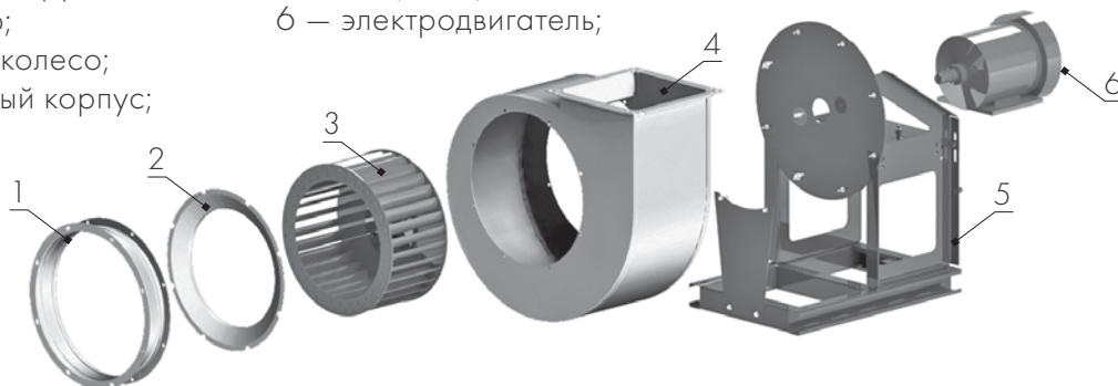
Рис. 4. Устройство и основные элементы радиального вентилятора
