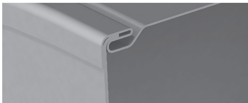
Рис. 5. Сборка корпуса вентилятора на «питтсбургском фальце».
