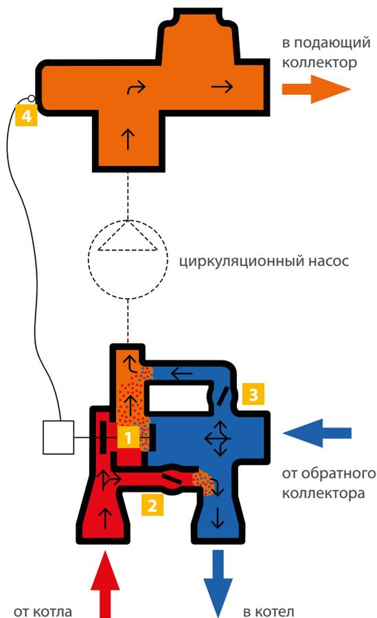
Смесительный узел Neptun IWS состоит из двух частей – непосредственно насосно-смесительной части и байпаса с перепускным клапаном избыточного давления.
