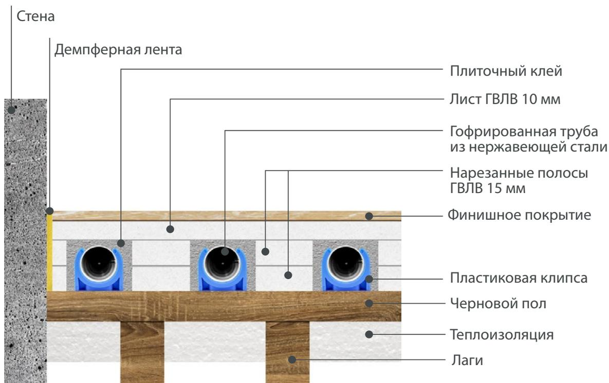
1. По всему периметру помещения, без пропусков, укладывается **демпферная лента**. Для повышения удобства и уменьшения времени монтажа демпферная лента Neptun IWS имеет клеевой слой по всей площади одной из сторон ленты.
