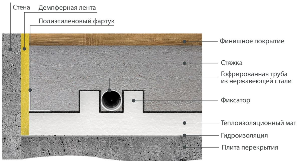
1. На выровненную и чистую поверхность укладывается слой **гидроизоляции** (полиэтиленовая пленка толщиной не менее 0.2мм). Гидроизоляция необходима, если под перекрытием, на которое укладывается теплый пол, находится холодный неотапливаемый подвал или грунт.
