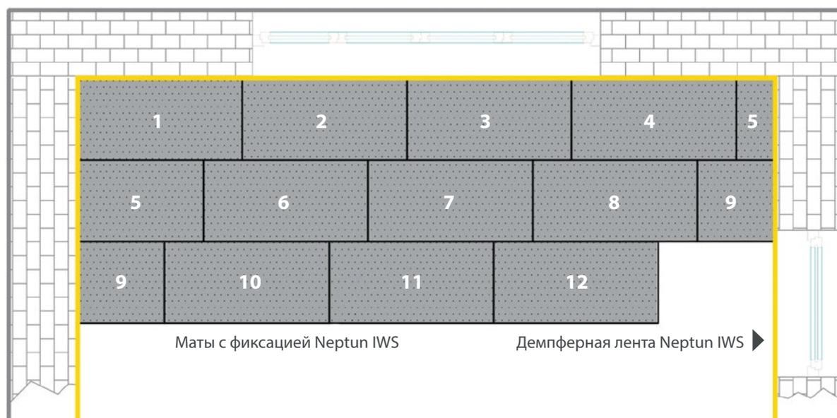
Следует обратить внимание, что теплоизоляционные маты укладываются по всей площади пола обогреваемого помещения независимо от того, будут ли укладываться трубы теплого пола по всей площади или нет. Это обеспечивает однородность структуры пола (получим «плавающую» стяжку по всей площади), а следовательно, его прочность и надежность.
