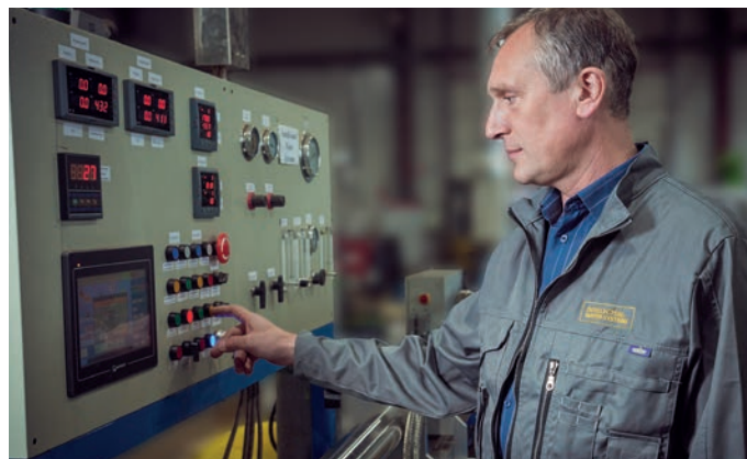
Контроль процесса отжига гофрированной трубы IWS
