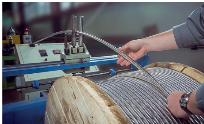
Подача гофрированной трубы IWS для отжига
