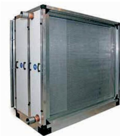
**Калориферы** предназначены для подогрева воздуха в каналах систем вентиляции и кондиционирования. Согласно СНиП 41-01-2003 «Отопление, вентиляция и кондиционирование» температура подаваемого воздуха должна быть не менее 15°C. Поэтому одна приточная вентиляционная система, рассчитанная на работу в переходное и холодное время года, не обходится без встроенного воздухонагревателя.
