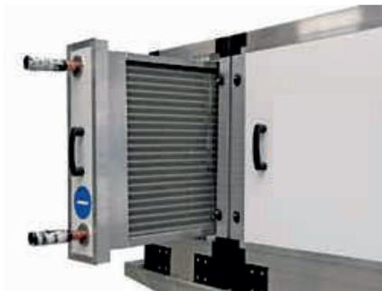
Предназначены для охлаждения поступающего в приточный агрегат воздуха. Воздухоохладитель представляет собой теплообменник, состоящий из медных трубок с алюминиевым ребрением, непосредственно встраиваемый в вентиляционную систему.
