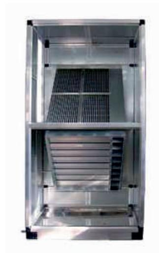
**Рекуператор** (от лат. recuperator — получающий обратно, возвращающий) — теплообменник, применяемый в системах вентиляции и кондиционирования для возврата тепла, содержащегося в удаляемом воздухе для нагрева приточного воздуха.
