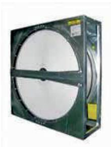
**В роторных рекуператорах** тепло передается вращающимся между удаляемым и приточным каналами ротором. Роторные рекуператоры применяются преимущественно в «чистых помещениях» так как грязь и запахи могут перемещаться из удаляемого воздуха в приточный. Этого в некоторой степени можно избежать если правильно разместить вентиляторы.
