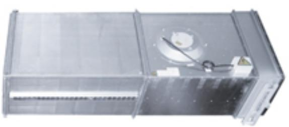
Воздушно-тепловые завесы относятся к промышленному типу оборудования и применяются для защиты открытых проемов от попадания холодного наружного воздуха. Завесы устанавливаются внутри помещения сбоку или над проемом. Выпускаются как без нагрева, так и с водяными или электрическим обогревом воздуха.
