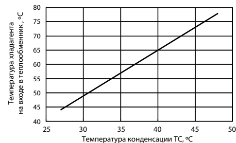
Рис. 2. Температура хладагента на входе в теплообменник
