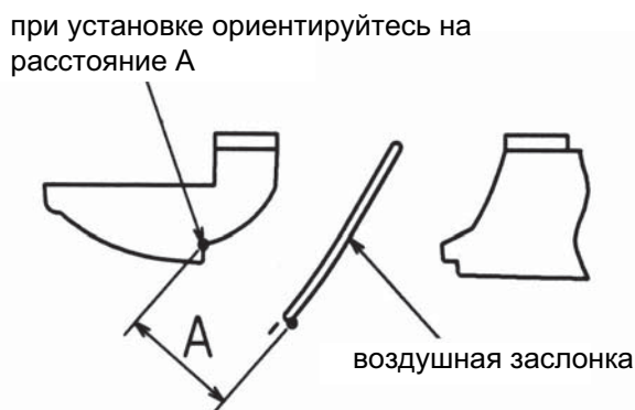
Допустимый диапазон установки заслонки
