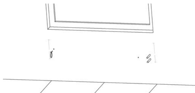
Рис. 5: Предварительно просверлите крепежные отверстия. Подвести трубы или кабель питания.
