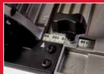
Параллельный упор с двумя направляющими крепится спереди и сзади пилы
