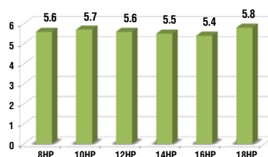
Коэффициент сезонной эффективности (охлаждение) до 5.8 (8 и 18HP). Средний IPLV до 5.6 HP.
