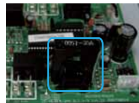
Защита компрессора по току
