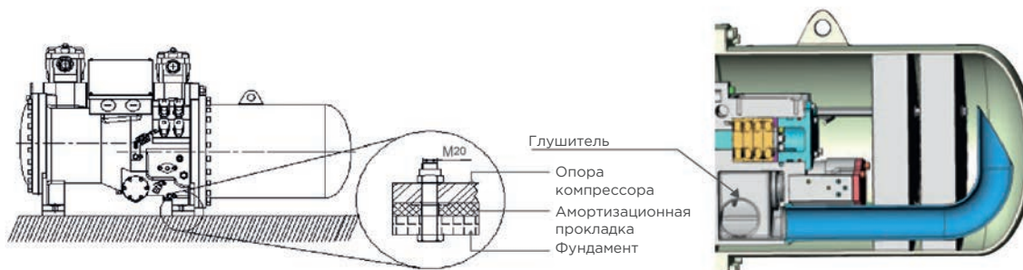
Схема монтажа амортизационной прокладки
