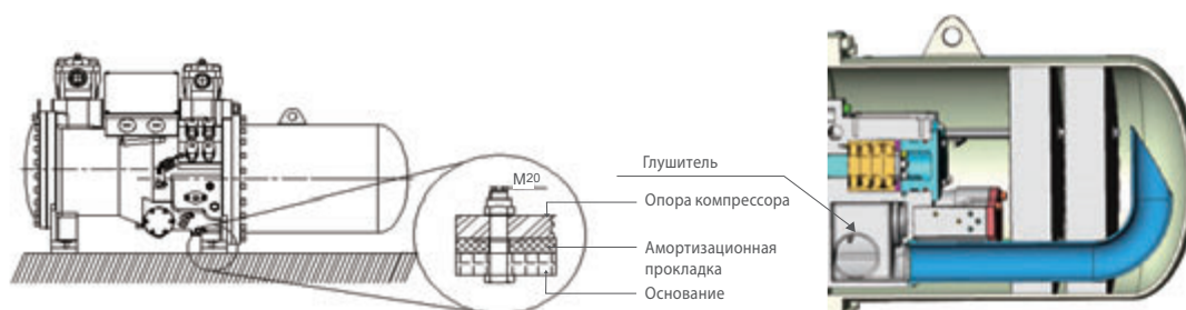
Схема монтажа амортизационной прокладки
