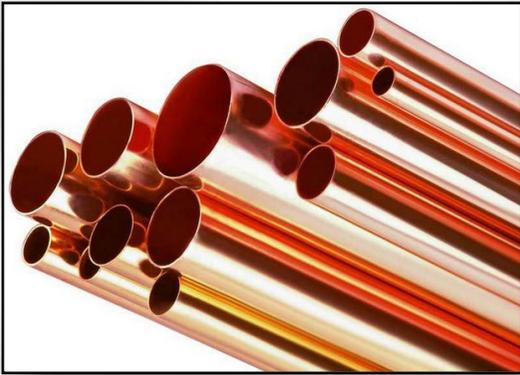
Медные холоднокатаные трубы более жесткие, лучше противостоят ударным нагрузкам. Кроме того, они имеют круглое поперечное сечение, не требующее калибровки, аккуратно обрезаны под углом  $90^\circ$ . Места холоднокатаных труб большого диаметра, подлежащих деформированию (вальцовке, изгибу, изготовлению раструба), необходимо отжигать. Трубы такого типа используются вместе с фитингами (уголками, тройниками) для монтажа коммерческих систем и поставляются длиной 4 и 6 м.
