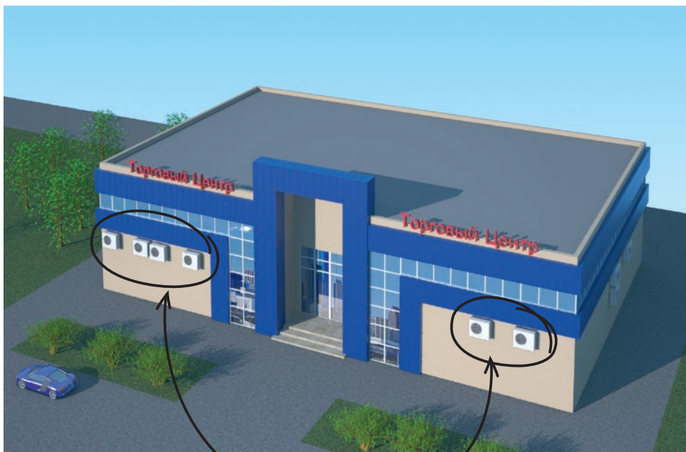
Наружные блоки сплит-систем
