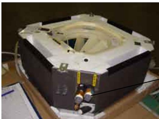
Патрубки подключения воды оборудованы внутренней резьбой BSP 3/4".
