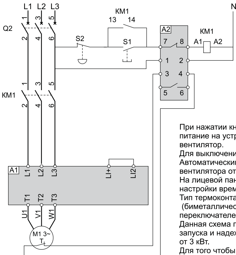
Схема подключения, двигатель вентилятора оснащен термоконтактами
