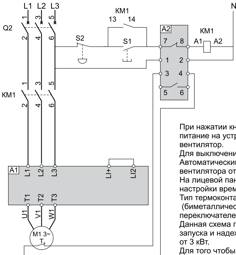
Схема подключения, двигатель вентилятора оснащен термоконтактами
