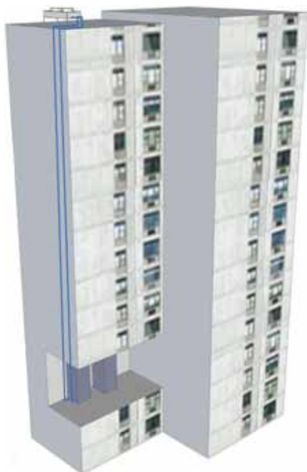
Пример размещения кондиционера и сухого охладителя
