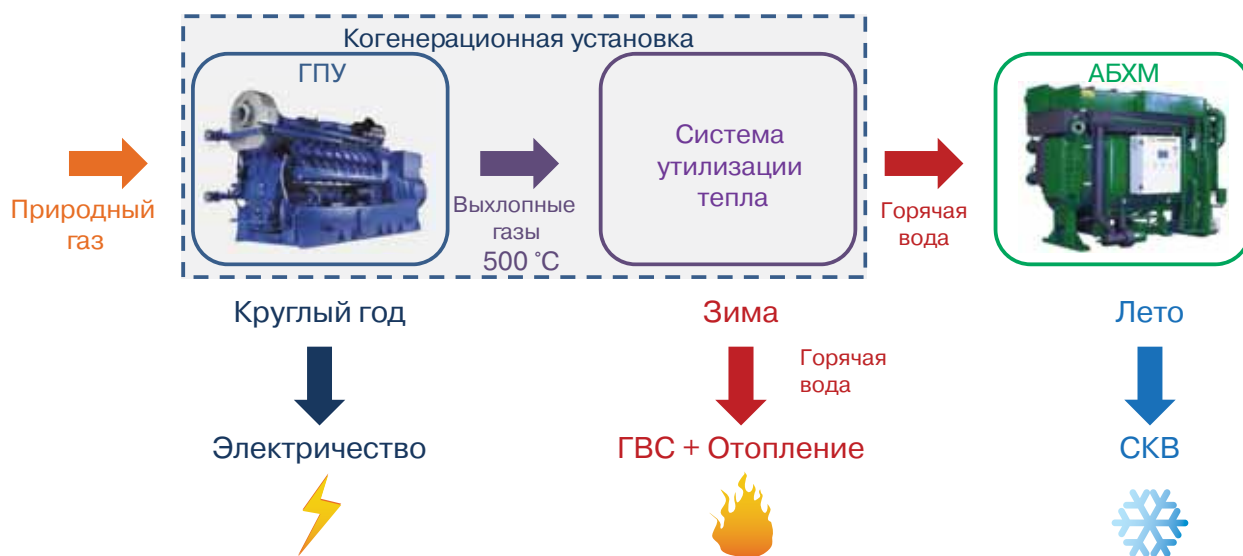
Рис. 2. Вариант применения АБХМ в системах тригенерации
