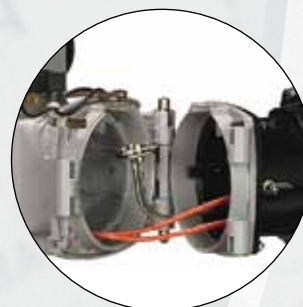
Шарнирное открытие для контроля головки горения
