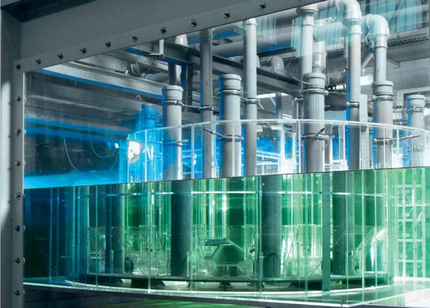
Функциональная модель для предотвращения отложений твердых веществ в канализационной насосной станции.
