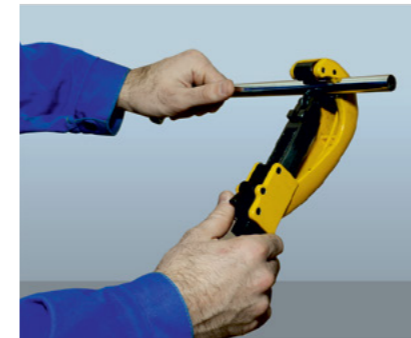
(4) Отрезать с помощью трубореза
