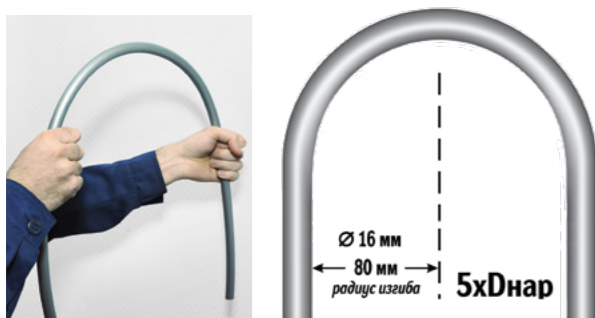
Минимальный радиус изгиба труб КОНТУР G-RAY
