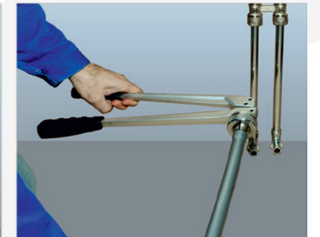
(6) Подвести трубо-провод необходимой длины, затем расширить конец трубы
