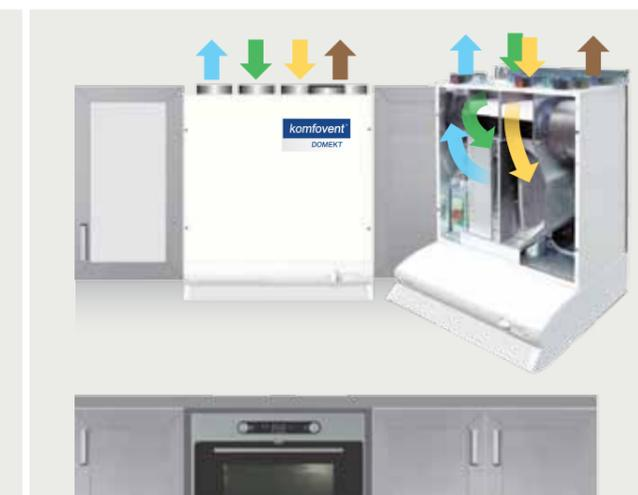
**Почему?** Потому что во время приготовления пищи Вы включаете кухонную вытяжку, и тем самым открываете при помощи внутреннего клапана воздушный обводной канал. И использованный после приготовления пищи воздух вытягивается вытяжным вентилятором и не проходит через ротор, а направляется через обводной канал. При необходимости, вытяжной вентилятор легко можно извлечь и очистить.
