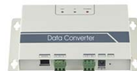
Шлюз для подключения к системе диспетчеризации
