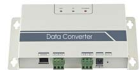
Шлюз для подключения к системе диспетчеризации
