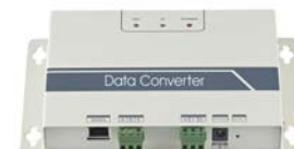
Шлюз для подключения к системе диспетчеризации
