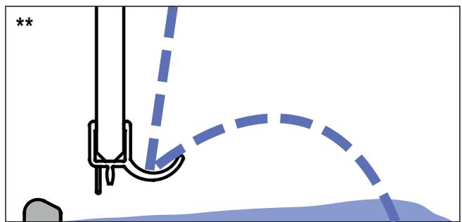
Специальный горизонтальный уплотнительный профиль в отличие от обычных уплотнительных профилей отталкивает даже быстро стекающую воду. Улучшенная гидроизоляция душевой кабины.
