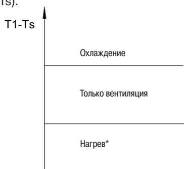
Нагрев\* В моделях только с режимом охлаждения будет работать вентилятор. Скорость вентилятора внутреннего блока для соответствующего режима будет выбираться автоматически. Жалюзи функционируют в соответствии с выбранным режимом. При переключении режимов нагрева и охлаждения компрессор остановится на определенное время, а затем кондиционер выберет определенный режим в соответствии со значением  $T1 - Ts$ . При изменении заданной температуры кондиционер выберет режим работы снова.
