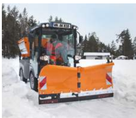
MC 130 со снегоборочным плугом
