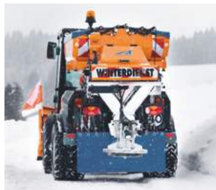
MIC 84 с навесным разбрасывателем
