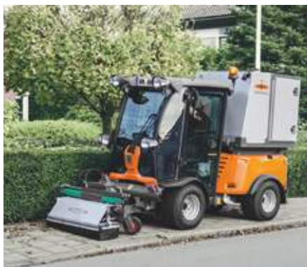
MIC 50 с агрегатом для удаления сорняков
