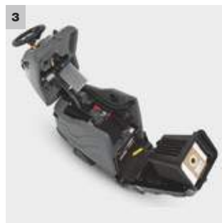
3 Откидные элементы обшивки
