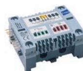
расширительный насосный модуль к колодке Premium 24 В
