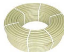
труба PE-Xc соотв. DIN 16892/93 с антидиффузионной защитой соотв. DIN 4726 в отрезках для системы ц.о., холодного и горячего водоснабжения
