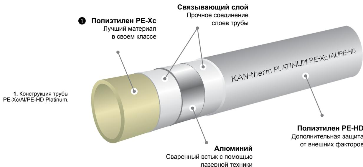
Трубы PE-Xc/Al/PE-HD Platinum доступны в диапазоне диаметров 14-32 мм и поставляются в бухтах по 25, 50 или 200 м. Размеры труб Platinum адаптированы к стандартным фитингам Системы KAN-therm Push.
