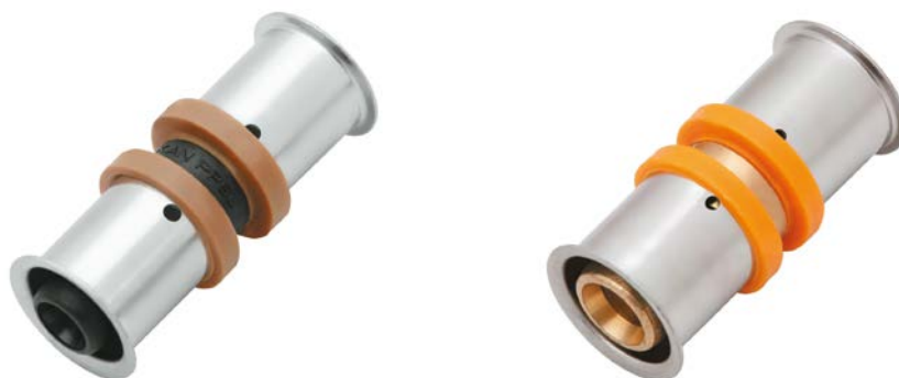
Рис. 50. Двухсторонний соединитель KAN-therm Press LBP для многослойных труб 16 × 2; 20 × 2; 25 × 2,5
