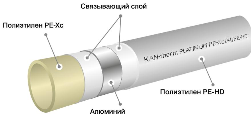
Конструкция трубы с антидиффузионным покрытием
