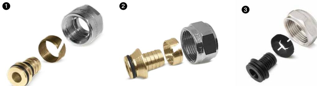
Соединение выполняется в той же последовательности, как описано выше. Следует помнить, что после накидывания на трубу обжимной гайки, нужно надеть разрезанное кольцо, а перед завинчиванием гайки передвинуть кольцо в направлении края трубы. Диапазон диаметров присоединяемых труб и размер гаек: Ø16 G½", Ø16 G¾", Ø20 G¾" (для многослойных труб) и Ø16 G¾", Ø20 G¾" (для труб PE-RT и PE-Xc).
