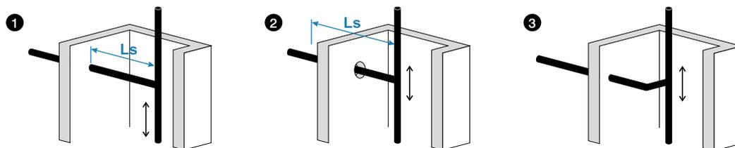
В случае труб Системы KAN-therm Push и PP можно отказаться от компенсации удлинения, располагая неподвижные опоры непосредственно при каждом тройнике ответвления трубопровода. Это, так называемый, жесткий монтаж ("рис. С" на странице 116). С помощью деления стояка (неподвижными опорами) на относительно короткие участки (часто с длиной, равной высоте этажа, не больше 4 м), величина удлинений также будет небольшой, а возникшие напряжения будут компенсироваться посредством хомутов неподвижных опор.
