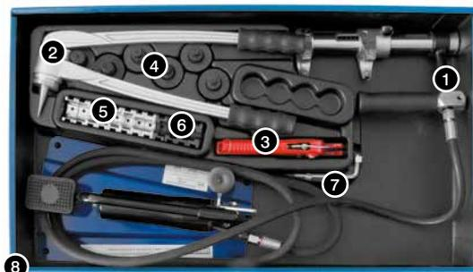
1. пресс гидравлический с ножным приводом;
