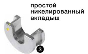
— В случае монтажа фитинга PPSU диаметра Ø32 мм необходимо использовать со стороны фитинга простой никелированный вкладыш Ø25, а со стороны кольца - щеки пресса.
