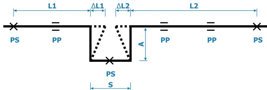
Компенсатор П-образный для стальных труб
