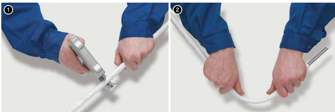
В случае соединителей KAN-therm Press LBP не требуется снимать фаску с внутреннего края трубы, при условии применения острого режущего инструмента и осевого монтажа трубы с фитингом! При больших диаметрах (25 мм и выше) для облегчения вставки штуцера соединителя в трубу рекомендуется воспользоваться калибратором. Для диаметра 40 мм калибровка трубы является обязательной.
