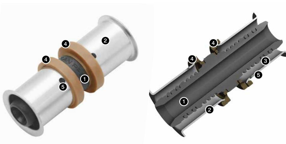
**LBP – „Leak Before Press”** - утечка в местах неопрессованных соединений. Ошибочно неопрессованное соединение сигнализирует утечкой уже во время заполнения водой смонтированной системы, еще до испытаний давлением. Эта функция соответствует предписаниям DVGW („контролируемая утечка”).
