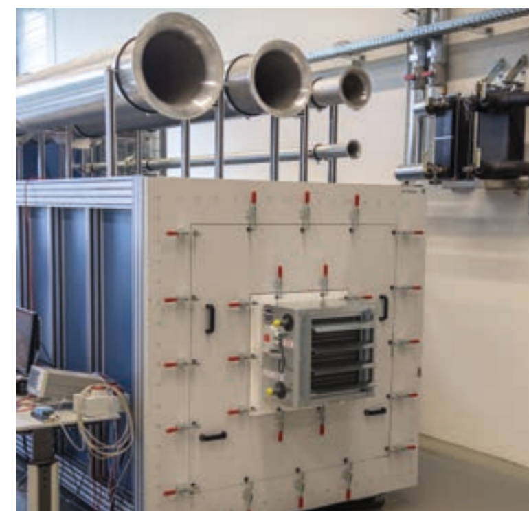
Проведение испытаний по измерению мощности воздуха в соответствии с EN ISO 3745 (ранее - DIN 24163); Научно-исследовательский центр Kamrann
