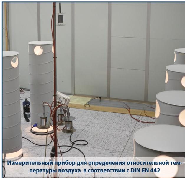
Измерительный прибор для определения относительной температуры воздуха в соответствии с DIN EN 442
