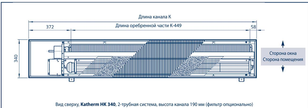
Вид сверху, Katherm HK 340, 2-трубная система, высота канала 190 мм (фильтр опционально)
