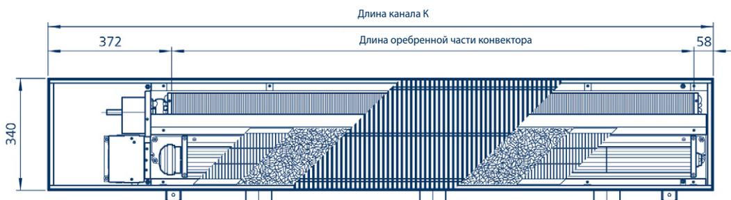
Вид сверху Katherm НК 340, высота канала 190 мм, с возможностью подачи приточного воздуха
