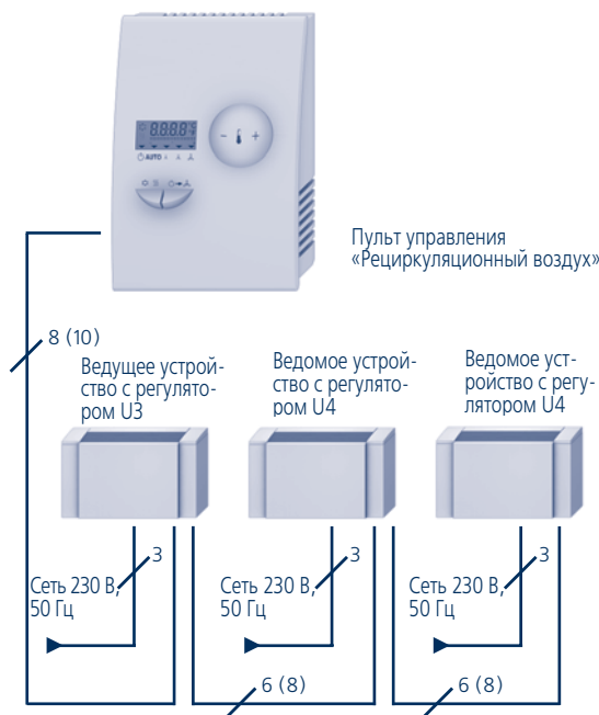
Регулятор U3: выносной блок управления для настенного монтажа Регулятор U4: ведомое устройство в системе группового управления
