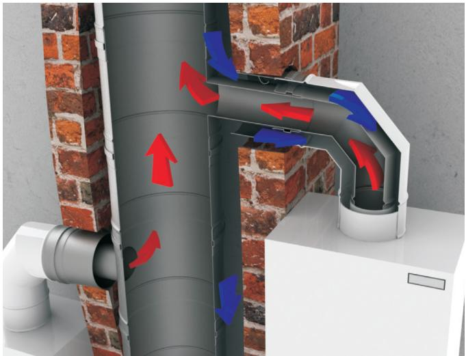
> Подключение к коллективному дымоходу может быть выполнено с применением одностенной системы Jeremias EW-FU, работающей под разряжением. Данное решение состоит из отдельной дымоотводящей трубы и трубы, подающей воздух для горения.
