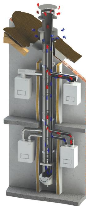
**Система LAS** – одностенная система дымоудаления для газовых котлов с закрытой камерой сгорания, предназначенная для многоквартирных жилых домов. Она дает возможность подключения 10 котлов в один дымоход. Система должна быть установлена в шахте, из которой к котлам будет поступать воздух для горения. Крышка шахты LAS имеет специальную конструкцию для обеспечения отвода дымовых газов и подачи воздуха для горения.
