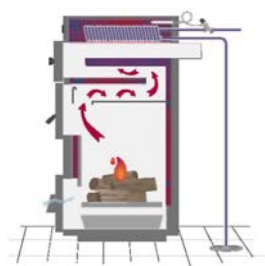
Дровяной котел YPV в поперечном разрезе
