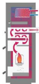
Пеллетный котел Pelletti 20 в поперечном разрезе
