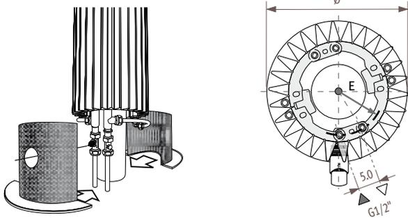
Стандартная поставка: включает защитный кожух и комплект соединений с термостатическим клапаном и запорным вентилем. Концовки для комплектов соединений с защитным кожухом, см. стр. 209.
