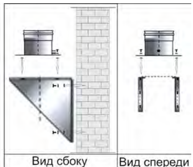
Рисунок 7б. Установка пары креплений с основой дымохода
