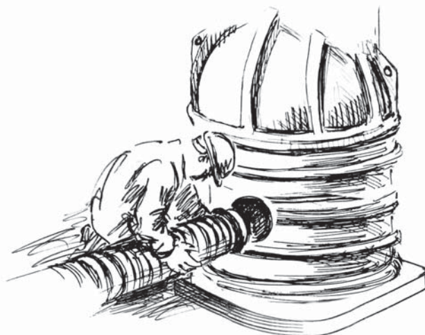
Рис. 5.3. Присоединение труб к колодцу
