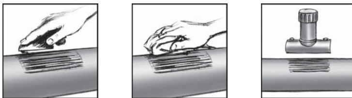
Рис. 2.12. Снятие оксидного слоя для установки седлового отвода
