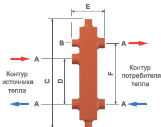
Габаритные и монтажные размеры разделительных модулей до 90 кВт и до 160 кВт
