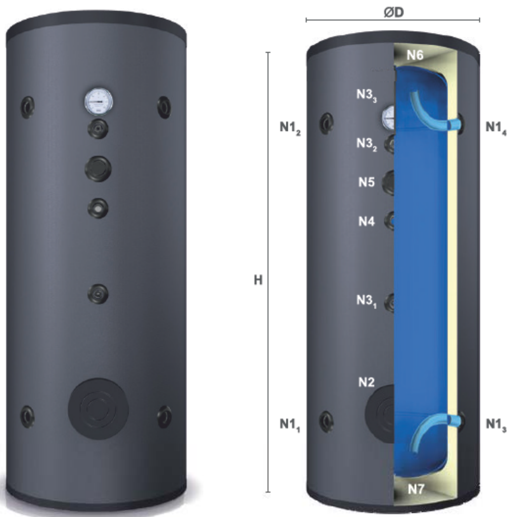
Внешний вид, сечение, и обозначение патрубков буферных ёмкостей ТАТ
