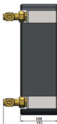
Габаритные и монтажные размеры теплообменника IC8Tx24 (30кВт)
