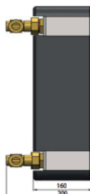
Габаритные и монтажные размеры теплообменника IC8Tx30 (40кВт)
