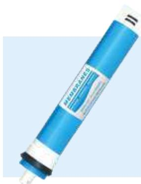
Четвертая ступень - основной элемент очистки воды - обратноосмотическая мембрана. Вода и растворенные в ней вещества разделяются, с одной стороны мембраны накапливается чистая вода, а все загрязнения остаются по другую ее сторону
