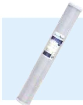
Вторая ступень GAC - картридж содержащий гранулированный активированный уголь (GAC), удаляет хлор и его соединения, органические вещества, газы, улучшает вкусовые качества.
