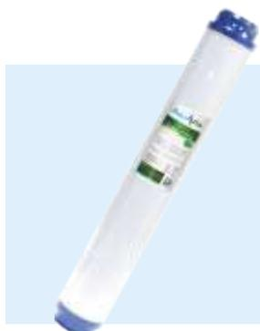
Третья ступень CBC-CarbonBlock) - картридж на основе спрессованного активированного угля (CBC-CarbonBlock), предназначен для доочистки воды от хлорорганических соединений и механических примесей размером до 1-5 мкм (микрон) или картридж тонкой очистки от механических примесей ~ 1-5 мкм (микрон)
