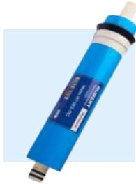
Четвертая ступень - основной элемент очистки воды - обратноосмотическая мембрана. Вода и растворенные в ней вещества разделяются, с одной стороны мембраны накапливается чистая вода, а все загрязнения остаются по другую ее сторону
