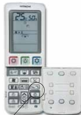
Кнопка автоматического выбора направления потока воздуха
