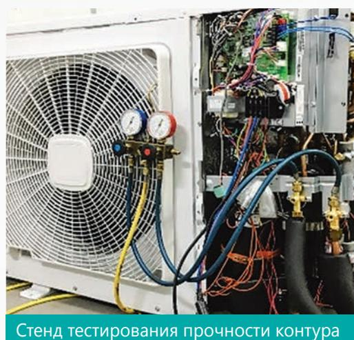
Стенд тестирования прочности контура
