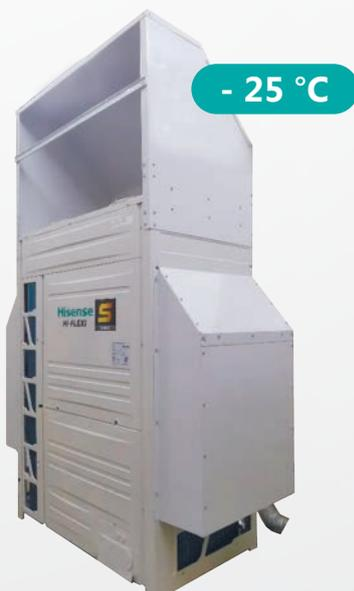
Наружные блоки VRF-систем серий SX и S HEAT RECOVERY способны работать в режиме охлаждения при окружающей температуре до -25 °C. Для этого блоки оснащаются специальными панелями, которые защищают теплообменник конденсатора от чрезмерного обдува холодным ветром, поддерживая давление конденсации на необходимом уровне. Для использования данной функции требуется обновить прошивку наружного блока.
