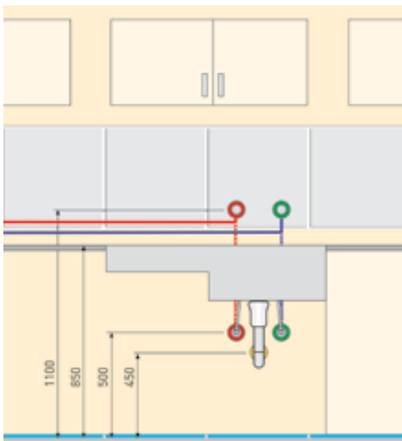
Присоединительные размеры для мойки на кухне
