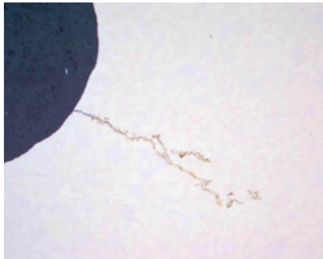
Трещина, отходящая от резьбы, вид под микроскопом
